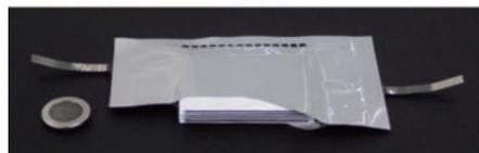
リチウム空気電池の原理図と10セルスタック
